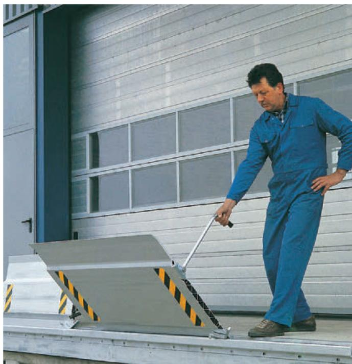
Für den Warentransfer auf der Rampe eignen sich diese speziellen Überfahrbrücken sehr gut. Sie überwinden kleine bis mittlere Höhendifferenzen und lassen sich von einer Person bedienen. Aus robustem, korrosionsfestem Aluminium gefertigt entsprechen sie den hohen Anforderungen im modernen Warenverkehr. Eine Steigung von mehr als 12,5% darf gemäß Berufsgenossenschaft bei Überfahrbrücken nicht überschritten werden.
