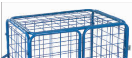
⑤ und ⑥ Mit Drahtgitterwänden, Türen und Dach. Stahlrohrrahmen mit eingeschweißtem Drahtgitter 100 x 100 x 5 mm, pulverbeschichtet
