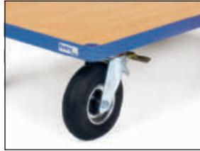
**Mehrpreis für Räder mit Luftbereifung** 220 x 70 mm, Tragkraft 400 kg, erst ab Wagenbreite von 600 mm möglich, kein TOTALSTOP möglich
