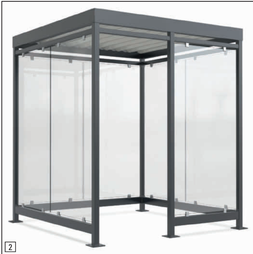
Modellreihe Köln K2 b/c in RAL 7016 als Raucherunterstand, 2165 x 2165 x 2510 mm (B x T x H), Rück- und Seitenwände aus ESG-Scheiben mit Glashaltern befestigt.
