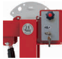
Optional: Systemschlosskasten mit Profilhalbzylinder 30/10 und Feuerwehr-Dreikant ähnlich DIN 3223 mit Edelstahl-Riegelbolzen und automatischer Verriegelung in den Endlagen.
