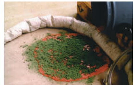
Schnelle Leckageeindämmung mit dem Saugschlauch. Problemzone eingrenzen – Abstreuen und Binden.
