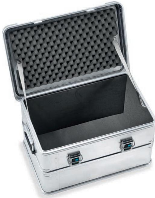
Langlebige und abriebfeste Auskleidung durch physikalisch vernetzten PE-Schaum in Boden und Wänden (Raumgewicht 40 kg/m<sup>3</sup>, Stärke 11 mm) sowie 15 mm Noppenschaum im Deckel. Einfacher Einbau durch selbstklebend ausgestattete Wände und Deckel. Der Boden wird eingelegt.
