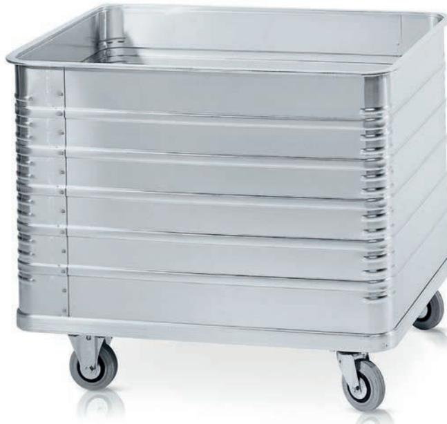
Robust und langlebig durch viele Qualitätsmerkmale, z.B. stabiles, groß dimensioniertes Rand- und Bodenprofil, durch hochfesten Formschluss dauerhaft mit Mantel- und Bodenblech verbunden, vernieteten Mantelstoß und geschweißte Rahmenprofile. Hohe Stabilität durch Stirn- und Seitenwandverstärkung mit umlaufenden Sicken und Ecksicken. Hoher Fahrkomfort durch leichtlaufende und gummibereifte Rollen, spurlos, rollengelagert, mit Fadenschutzscheiben.
