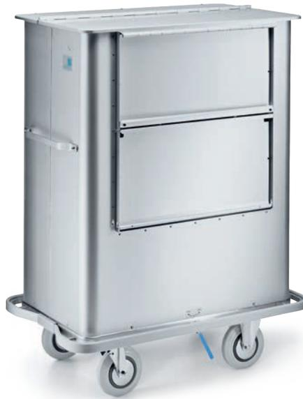
Vielfältig einsetzbarer Transportwagen mit Deckel zum Schutz der Güter. Glatte Wände ohne Sicken. Stabiles, groß dimensioniertes Rand- und Bodenprofil, durch hochfesten Formschluss dauerhaft mit Mantel- und Bodenblech verbunden. Wagenboden mit Ablaufschrägen und Ablaufhahn. 3-geteilter Deckel-Klappmechanismus und eine Vorderwandklappe. Kunststoffgepolsterter, umlaufender Abweiserahmen. Schiebegriff an Lenkrollenseite.
