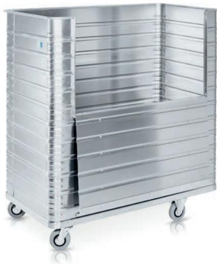
Robuste Transportlösung mit leichter, ergonomischer Erreichbarkeit der Güter durch große Klappe. Stirn- und Seitenwandverstärkung durch umlaufende Sicken und Ecksicken für hohe Stabilität. Stabiles, groß dimensioniertes Rand- und Bodenprofil, durch hochfesten Formschluss dauerhaft mit Mantel- und Bodenblech verbunden. Eine Längsseite zur Hälfte abklappbar für bequemes Be- und Entladen.
