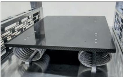
Aufnahmetisch, schwingend gelagert mit Gummipuffer oder Drahtseildämpfer
