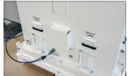
Wasserdampfdichter Behälter bei Dichtheitsprüfung durch Überdruck
