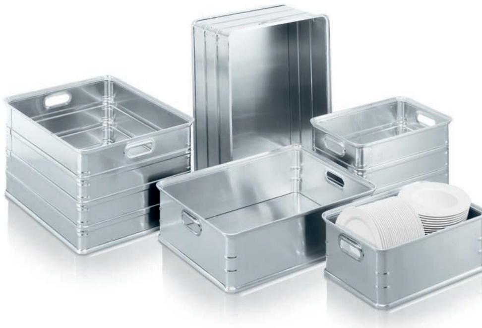
Universalkasten mit ergonomischen Schalengriffen für geschützte Lagerung und sicheren Transport bei jeder Temperatur. Abgestimmt auf Palettenmaße nach DIN 15 141. Für Rollenbahnen und Förderbänder geeignet. Hohe Stabilität durch Rand- und Bodenprofilrahmen aus Vollprofilen und vollverschweißten Profilstößen. Auf Wunsch mit Codierleisten für Zielsteuerung.
